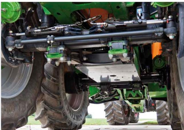
L'essieu hydro-pneumatique de l'UX 11201 Super permet un confort de conduite parfait et des rendements horaires maximaux
