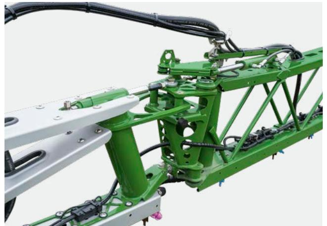
La sécurité de surcharge précontrainte hydrauliquement du tronçon d'extrémité avec un effacement fiable vers l'arrière, l'avant et le haut assure un pivotement fiable et une longévité élevée.
