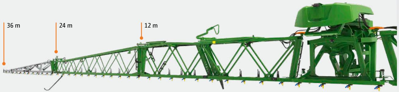
Rampe Super-L3 de 36 m, pouvant être réduite à 24 m et 12 m
