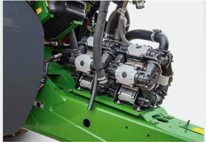
Le système double pompe de l'UX 11201 Super permet des débits d'aspiration jusqu'à 900 l/min
