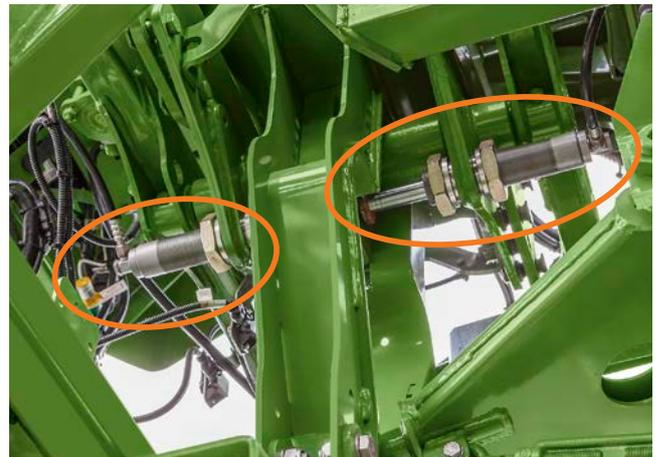
SwingStop est doté de deux vérins hydrauliques travaillant activement dans le cadre central de la rampe
