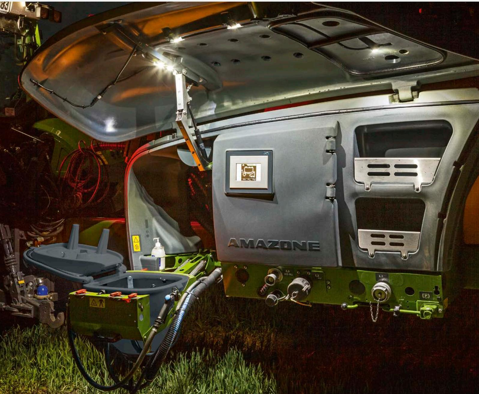
✔ SmartCenter avec pack Comfort plus et éclairage à LED, bien protégé sous le capot de protection
