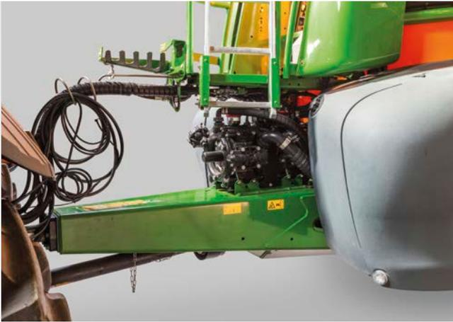
Le système double pompe de l'UX 4201 Super, UX 5201 Super et UX 6201 Super offre des capacités d'aspiration jusqu'à 700 l/min
