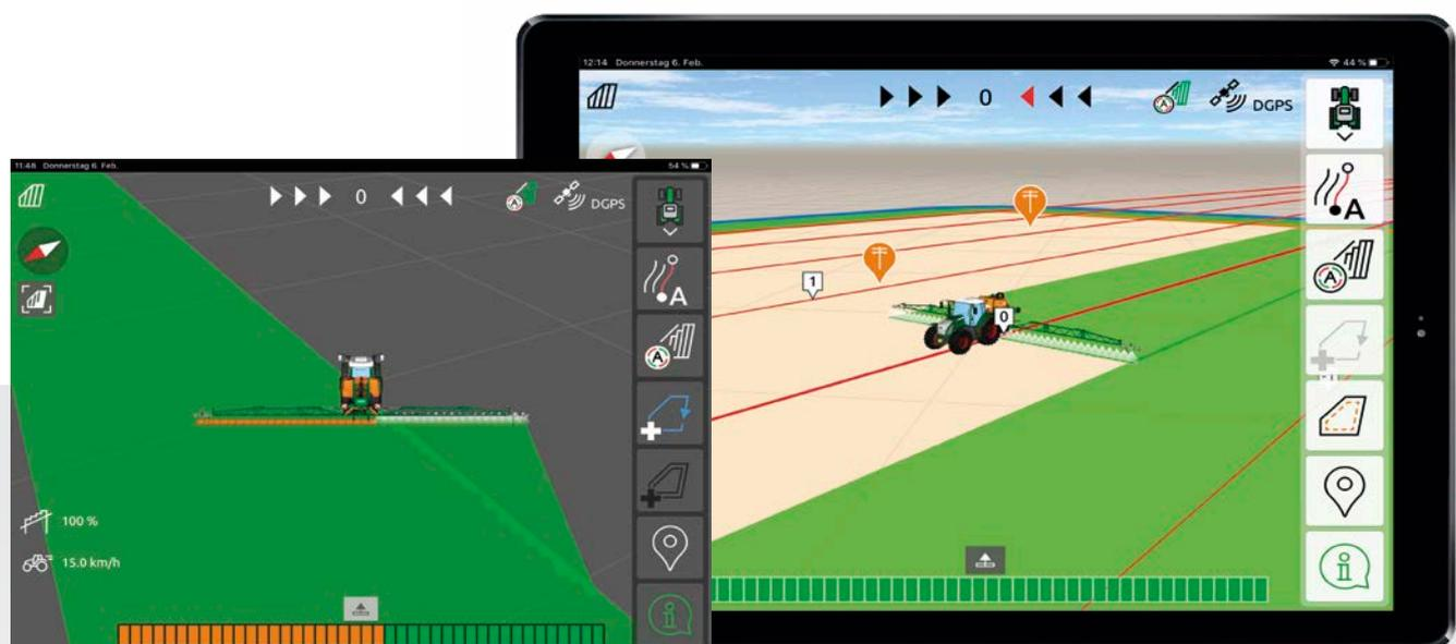
Mode d'affichage Cartes avec AmaTron Twin – Représentation claire de la machine et de ses tronçons et boutons de commande à droite de l'écran de la tablette
