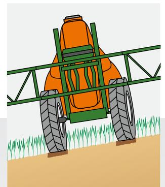
Commande active de correction automatique dans les dévers de l'essieu suiveur AutoTrail
