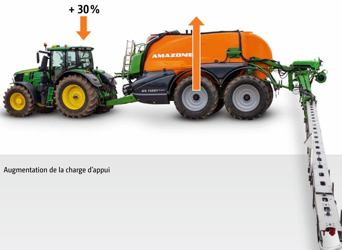
Augmentation de la charge d'appui
